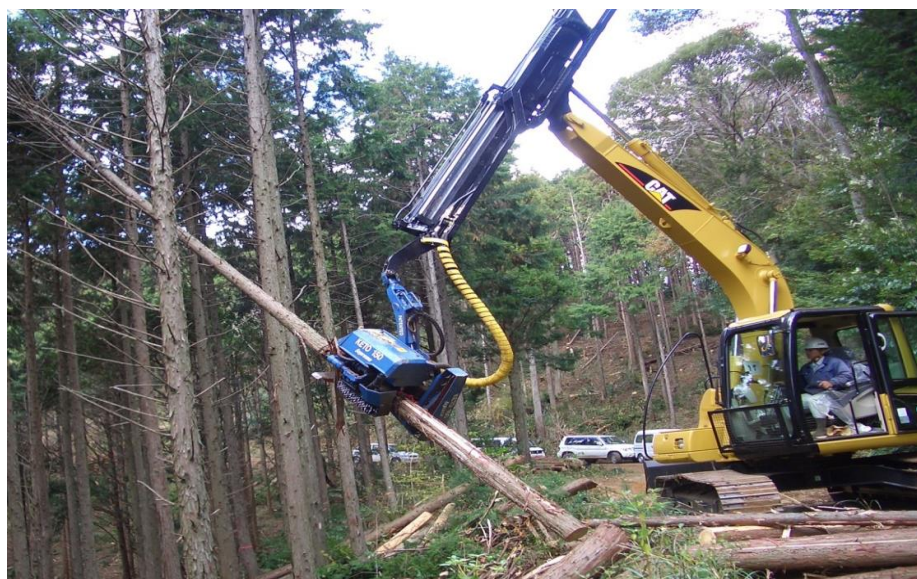
山林から 間伐材の 搬出作業
